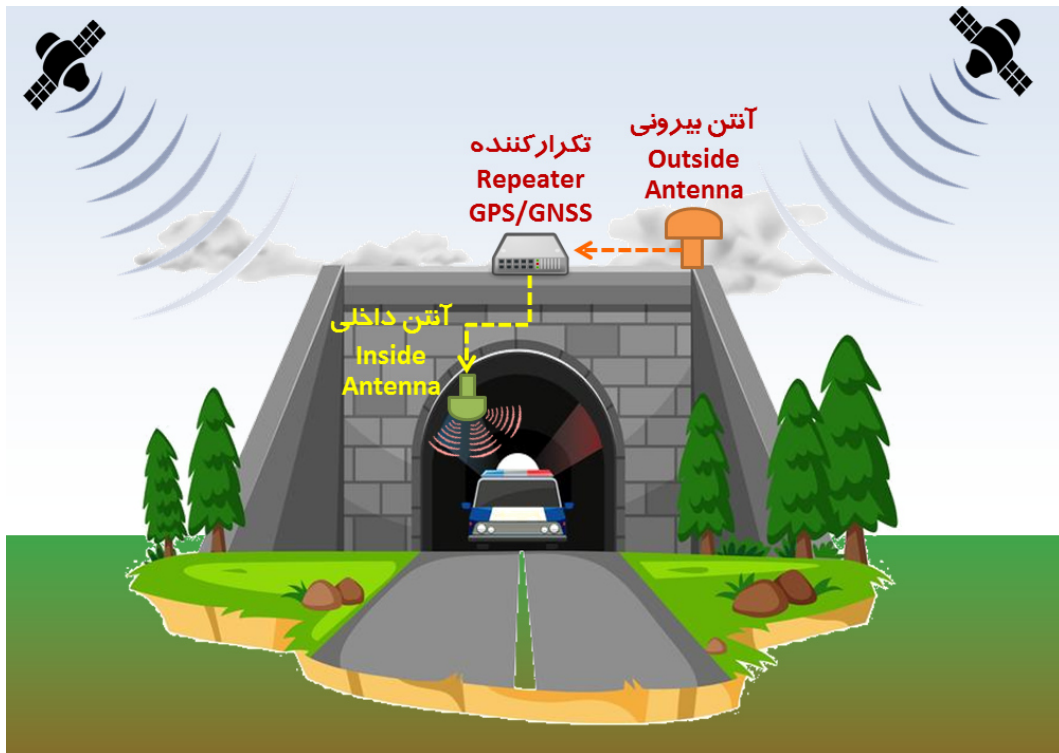
شکل (۴-۳۸) شماتیکی از نحوه کارکرد یک تجهیز تکرار کننده سیگنال GPS/GNSS برای رفع مشکل عدم دریافت سیگنالها در فضاهای محصور و بسته نظیر داخل سافتمانها و یا در داخل تونلها که امواج ماهواره‌ای به صورت مستقیم قابلیت دریافت ندارند؛ همانطور که در این شکل مشاهده می‌شود، با استفاده از یک تکرار کننده، سیگنال‌های GPS/GNSS، با یک نرف بالا و به صورت همزمان، از آنتن (گیرنده) بیرونی تکرار کننده دریافت شده و توسط آنتن (فرستنده) داخلی موجود در فضای محصور برای گیرنده‌های موجود در آن فضای محصور، ارسال خواهد شد.
