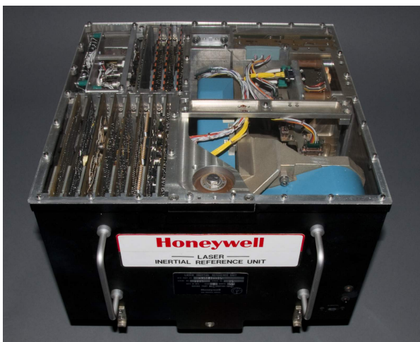
شکل (۱-۱۴) سمت راست: تصویری از «واحد اندازه‌گیری اینرسی، IMU» متعلق به فضاییمای آپولو؛ سمت چپ: تصویری از «واحد مرجع اینرسی یا در اصطلاح IRU» ۲ که اسم دیگری برای «واحد اندازه‌گیری اینرسی، IMU» است.
