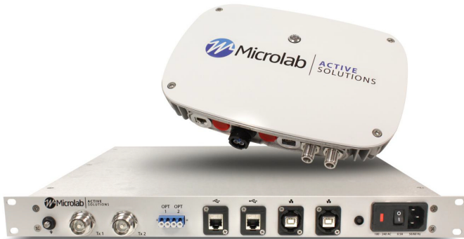
شکل (۴-۳۹) سمت راست: تصویری از یک آنتن تکرار کننده GPS که معمولاً بیرون از سافتمان و فضاهای محصور نصب می‌شود، سمت چپ: تصویری از تجهیزات دیمییتال تکرار کننده GPS قابل نصب در داخل سافتمان و فضاهای محصور
