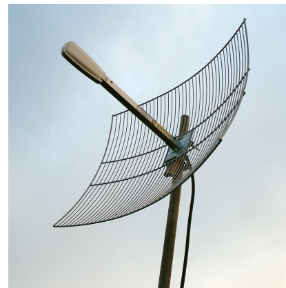
شکل (۵-۶) سمت راست: تصویری از یک آنتن جهت دار، یا در اصطلاح Directional، سمت چپ: شماتیکی از الگوی تابش یک آنتن جهت دار
